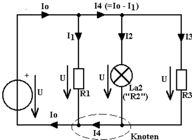
Spannung U: In einer Parallelschaltung ist die **Spannung** über allen Elementen **gleich gross**.
