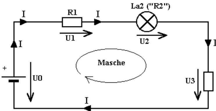
Strom I: In einer Serieschaltung ist der **Strom** durch alle Elemente **gleich gross**.
