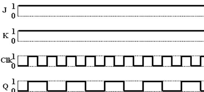
Feststellung: Q hat genau die doppelte Periodendauer oder halbe Frequenz wie Clk!
