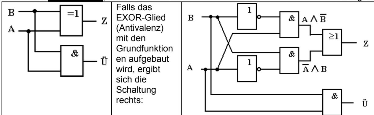
Für den Aufbau eines Addierwerks benötigt man Schaltungen, die **drei** Dualzahlen, nämlich die eigentlichen **Summanden** und einen allfälligen **Übertrag** zusammenzählen kann. Eine solche Schaltung heisst dann **Volladdierer**.
